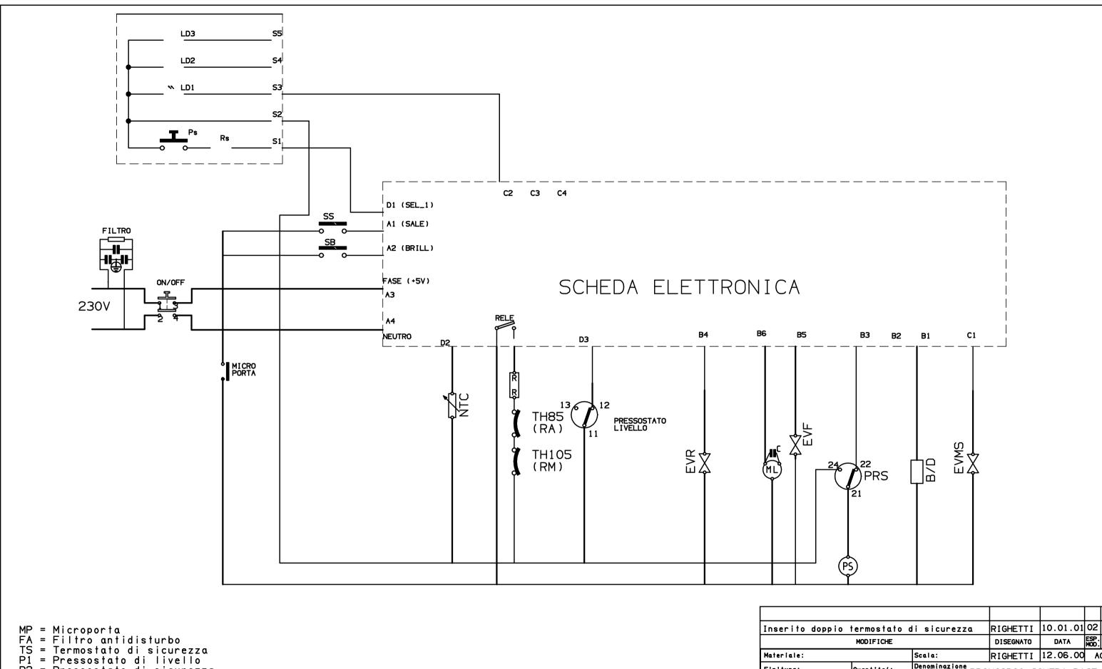
P2 = Pressostato di sicurezza AQS = Dispositivo acquastop SS = sensore sale SB = Sensore brillantante NTC = Sensore temperatura RR = Resistenza riscaldamento B/D = Dosatore brillantante / detersivo EVR = Elettrovalvola di rigenerazione EVM = Bobina 1/2 carico EVF = Elettrovalvola di carico ML = Motore lavaggio PS = Pompa scarico
